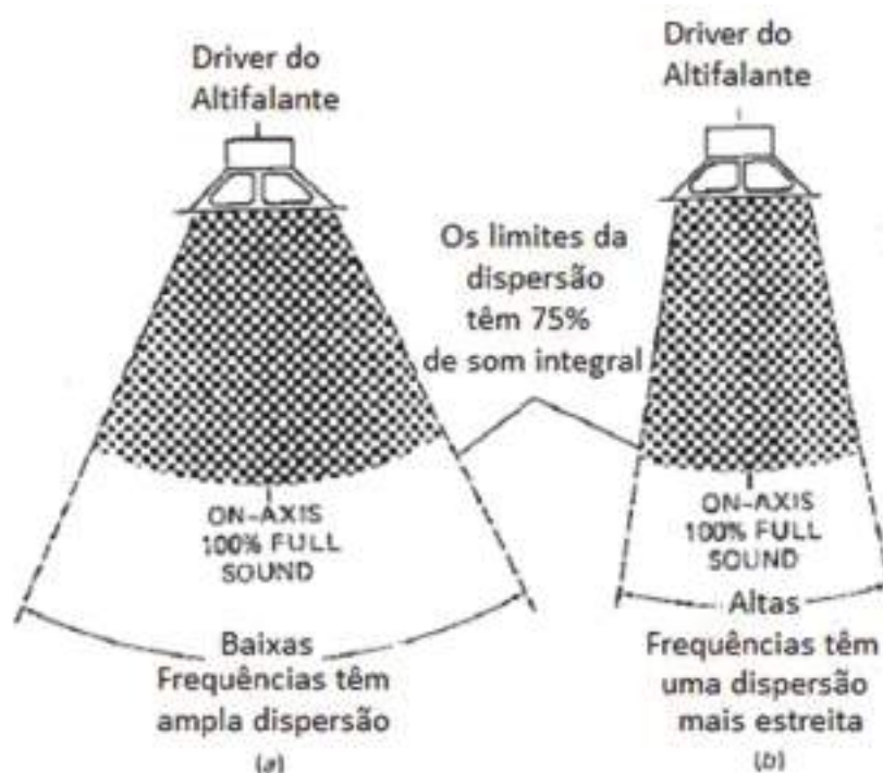
Figura 7 – Uma comparação de ângulos de dispersão para (a) baixa frequência e (b) alta frequência.
