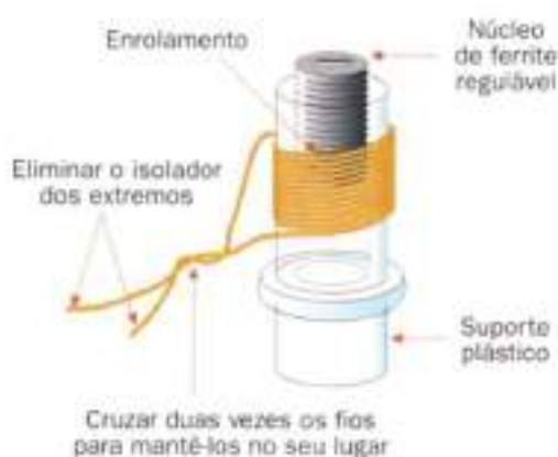
Figura 68 - Enrolamento da bobina L1; para a manter no seu lugar pode-se cruzar os fios um par de vezes.
